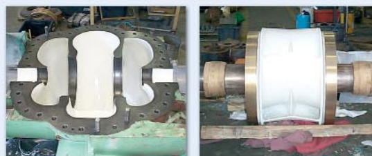
A korrodált és kopott tengely felújítása Loctite® 3478 Superior Metal alkalmazásával. Kikeményedés után méretre munkálással fejeződött be a tengely felújítása. Ezután az összes alkatrész bevonásra került Loctite® Nordbak® 7228 fehér színű ecsetelhető kerámiával (ivóvíz rendszerekben alkalmazhatósági bizonylattal rendelkezik).
