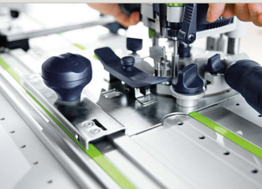
Lyuksorral ellátott vezetősín – a felsőmarót az adapterrel egyszerűen a 32-es osztású lyuksor mentén vezetjük.
