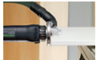
Műanyag- vagy tömör fa enyvező profilok lekerekítéséhez.
