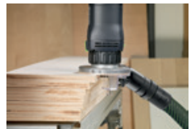
Műanyag- vagy tömör fa enyvező profilok éllétöréséhez.
